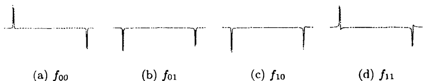
Рис. 5.29. Экспериментальные результаты, полученные на ЯМР-квантовом компьютере по определению f(0) \oplus f(1) (проблема Дойча); результат показан для каждой из четырех возможных бинарных функций f .
