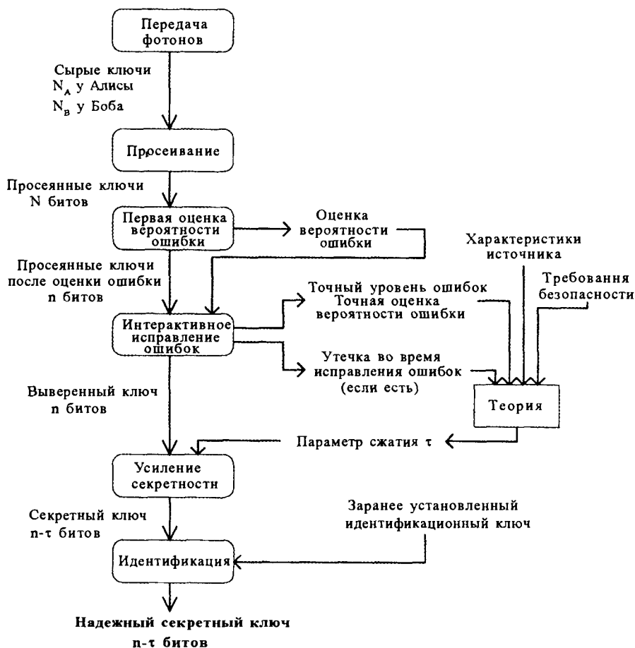
Рис.2.5. Диаграмма протокола распределения квантового ключа, основанного на одиночных фотонах.
