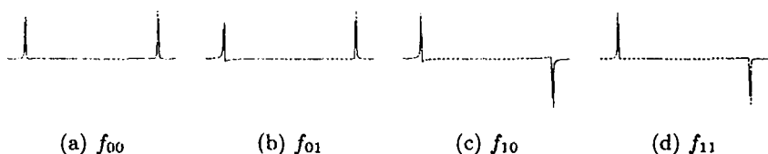
Рис. 5.27. Экспериментальные результаты, полученные на ЯМР-квантовом компьютере по определению f(0) ; результат показан для каждой из четырех возможных бинарных функций f .
