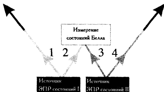
Рис. 3.22. Принцип обмена перепутыванием. Два ЭПР-источника излучают пары перепутанных фотонов 1-2 и 3-4. По одному фотону из каждой пары (фотоны 2 и 3) участвует в процессе измерения состояния Белла. Это приводит к процированию двух других фотонов 1 и 4 на перепутанное состояние. Изменение насыщенности линий обозначает изменение в наборе возможных предсказаний, которые могут быть сделаны о состоянии частиц.
