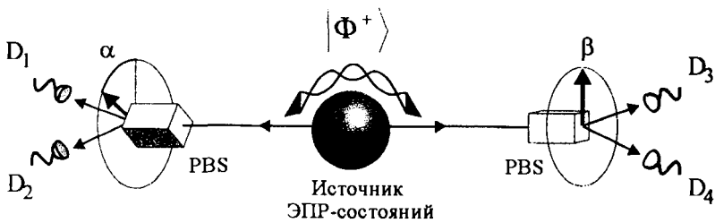
Рис. 1.8. Корреляционные измерения между детектируемыми событиями Алисы и Боба при различных выборах базисов детектирования (обозначенных углами \alpha и \beta ориентаций поляризационных светоделителей PBS) приводят к нарушению неравенств Белла.
