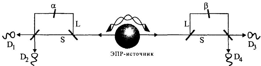
Рис. 3.2. Схема эксперимента типа Фрэнсона, по проверке интерференции перепутанных во времени фотонных пар. Измерения проводятся с помощью двух удаленных разбалансированных интерферометров Маха-Цандера. Фаза каждого интерферометра изменяется фазовращателем, расположенным в длинном ( L ) плече.
