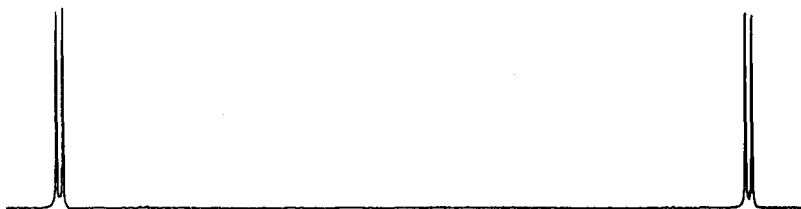
Рис. 5.25. ЯМР спектр ^1H в частично дейтерированном цитозине. Каждая пара линий это ЯМР-сигнал от двух ядер ^1H .
